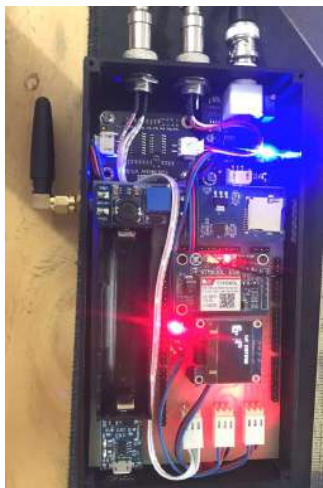
Gambar 5. Perangkat sistem pemantau volume dan keasaman nira (dipasang di samping penampung)
