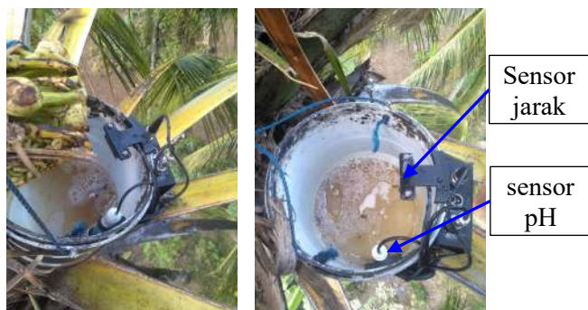
Gambar 6. Instalasi sensor jarak dan sensor pH pada penampung nira yang dipasang di atas pohon.
