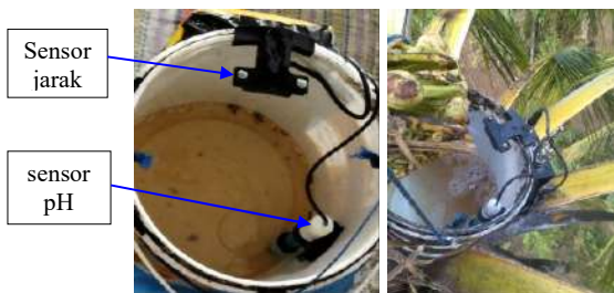
Gambar 6. Instalasi sensor jarak dan sensor pH pada penampung nira yang dipasang di atas pohon.
